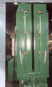
Lavage pièces hautes et étroites (tôles)
