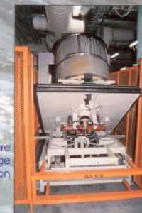
Lavage pièces hautes et étroites (tôles)
